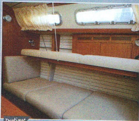
En soulevant le dossier, la couchette s'élargit et l'on dort calé contre le vaigrage. Dimensions : 2 m long, 0,80 m de large.
