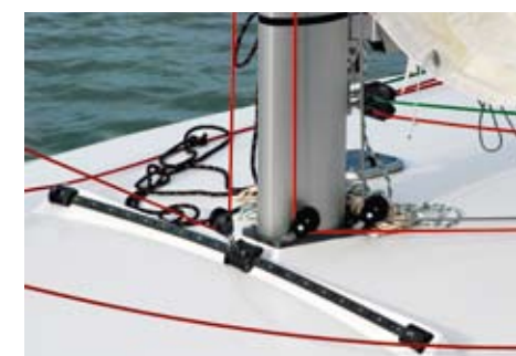
Devant le pied de mât s'étire le rail d'écoute de la trinquette autovireuse.
