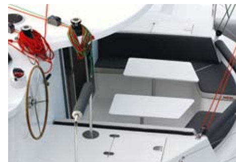
Les deux tables séparées ouvrent le passage de plain-pied de la plage arrière au carré.
