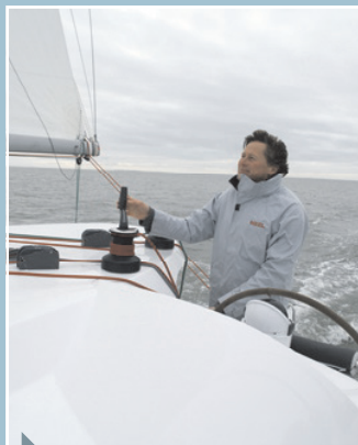
La position trop haute des winches de manœuvre.
